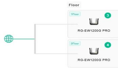
Gambar 3. Instalasi Router Mesh Wi-Fi di dua lantai Gedung
