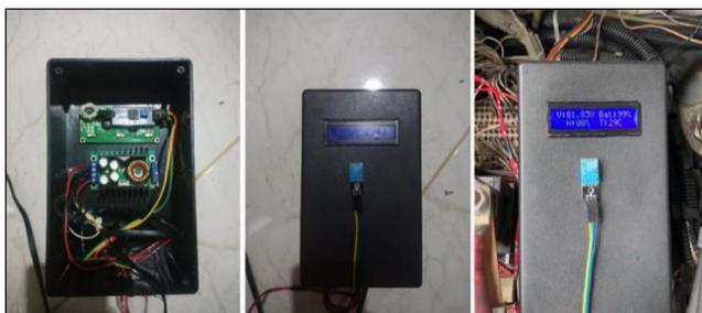
Gambar 6. Prototipe BMS
