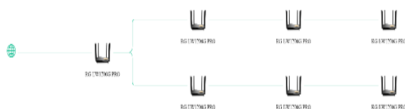
Gambar 2. Topologi Jaringan Mesh Wi-Fi
